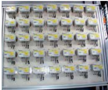
Testrack mit PU-Druckmessumformern
