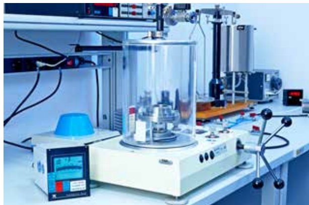
Kolbenmanometer im Druck-Kalibrierlabor von halstrup-walcher
