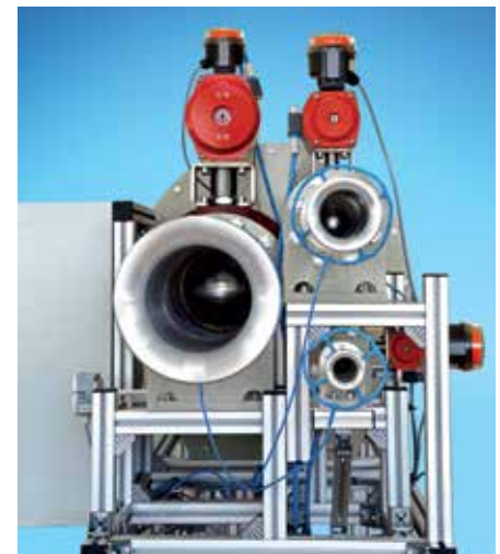
Hochgenaue Einlaufdüsen sorgen für präzise Messergebnisse
